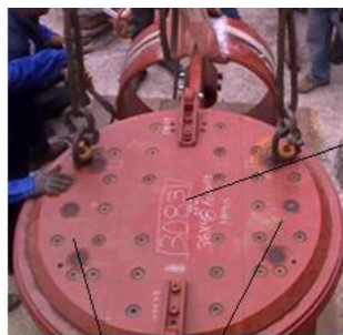
02 cánh van chặn khép bởi cơ cấu truyền động và gioăng cao su
