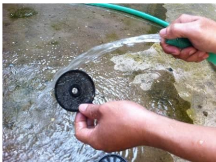
Vệ sinh lưới lọc
